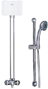
Elektrischer Klein-Durchlauferhitzer mit Mischbatterie zur wirtschaftlichen Warmwasserversorgung einer einzelnen Dusche im Temperaturbereich von etwa 35 °C bis 45 °C. Das Wasser wird unmittelbar während des Durchströmens erhitzt, so dass keine Wärmeverluste auftreten und jederzeit sofort warmes Wasser zur Verfügung steht. Zum Lieferumfang der Duschanlage gehört Brausegarnitur und Wandstange. Die spezielle Handbrause ist perfekt auf den sparsamen Durchfluss von weniger als 4 l/min abgestimmt.
