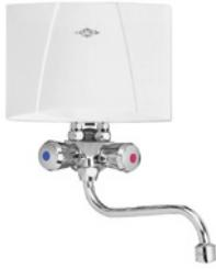
Elektrischer Klein-Durchlauferhitzer mit Mischbatterie zur wirtschaftlichen Warmwasserversorgung einer einzelnen Zapfstelle im Temperaturbereich von etwa 35 °C bis 50 °C. Das Wasser wird unmittelbar während des Durchströmens erhitzt, so dass keine Wärmeverluste auftreten und jederzeit sofort warmes Wasser zur Verfügung steht. Mit der hochwertigen Spezial-Mischbatterie wird das Gerät einfach auf einen 1/2"-Wasseranschluss an der Wand installiert.
